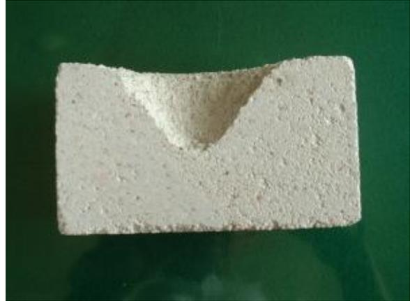
③耐火物解体用サンドブラスト材の磨耗試験
